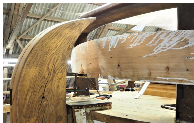
Den varme planke monteres rundt om agterstavnen
