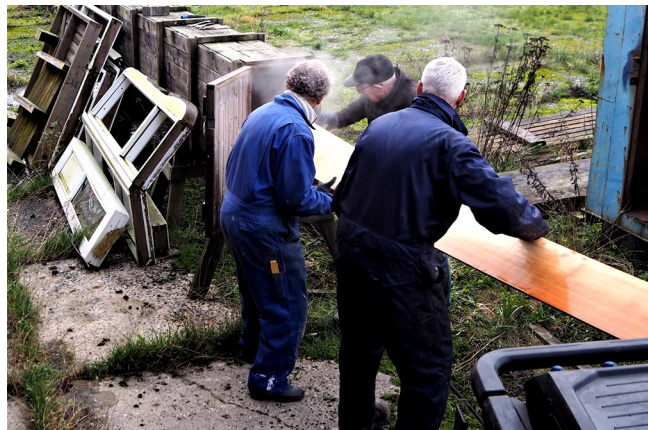
Planke til skanseklædningen varmes i svedekasse
